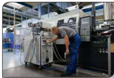
Rys. 1. System zmiennocięplnej regulacji temperatury ATT Variotherm firmy SINGLE w bliskiej odległości do wtryskarki
