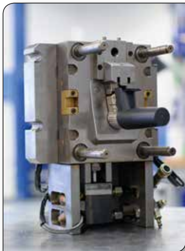
Rys. 3. Forma wtryskowa dla cylindrycznego uchwytu lampy diagnostycznej, którego rdzeń będzie poddany regulowanej temperaturze, w celu wyeliminowania skłonności do odkształcania
