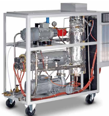
System termostataowania wodnego stanowisk kontrolnych do 200\text{ }^{\circ}\text{C} o mocy grzewczej 48\text{ kW} z wieloma funkcjami specjalnymi do zasilania napędzanej parą maszyny tłokowej; regulacja ciśnienia systemowego i temperatury wraz z zasilaniem regulowanym częstotliwością.
