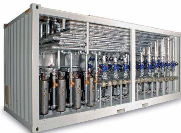
Kompaktowy kontener z wieloobiegową instalacją termostataowania i chłodzenia z olejem i wodą jako medium.
